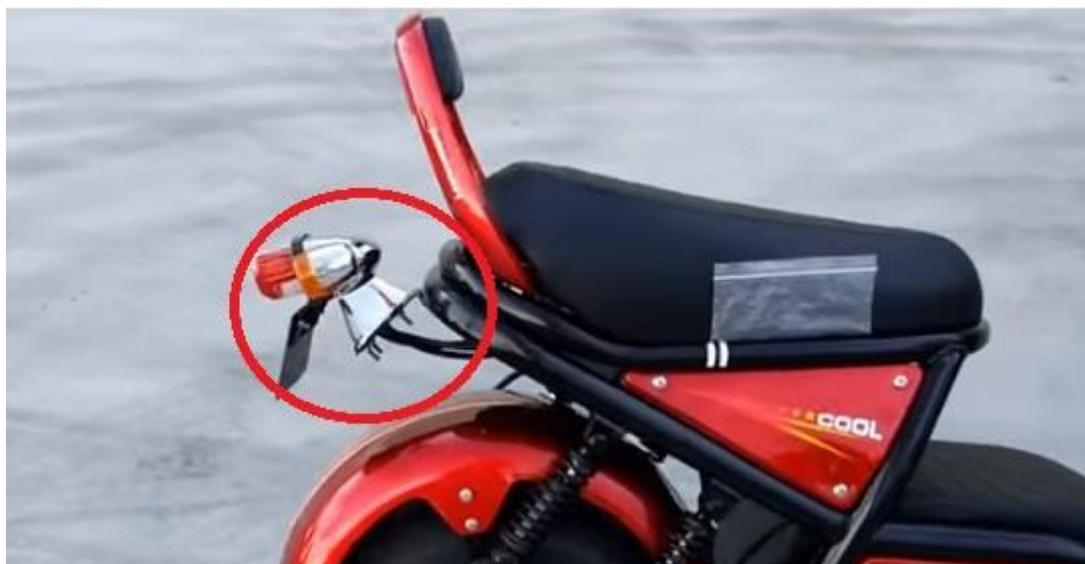
c. Kabeláž od zásního svĕtla protáhneme otvorem pod sedaĕkou dovnitř k řídící jednotce a zapojíme Obrázek
